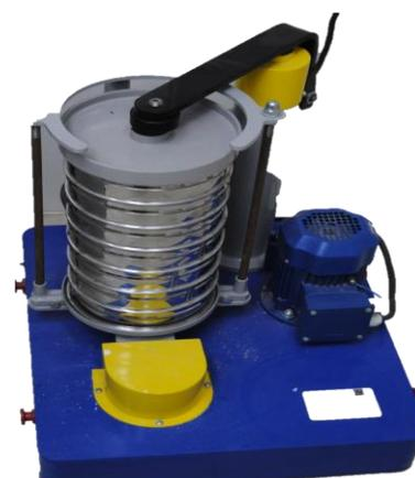
**Рис. 4. Ударный ситовой анализатор АС-200У**
