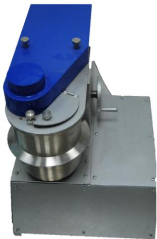
**Рис. 5. Тарельчатый гранулятор ТЛ-020**
