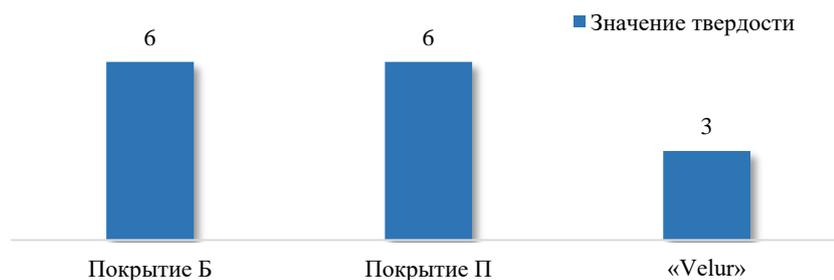
**Рис. 1.** Диаграмма результатов испытания на твердость образцов шкалой Мооса
